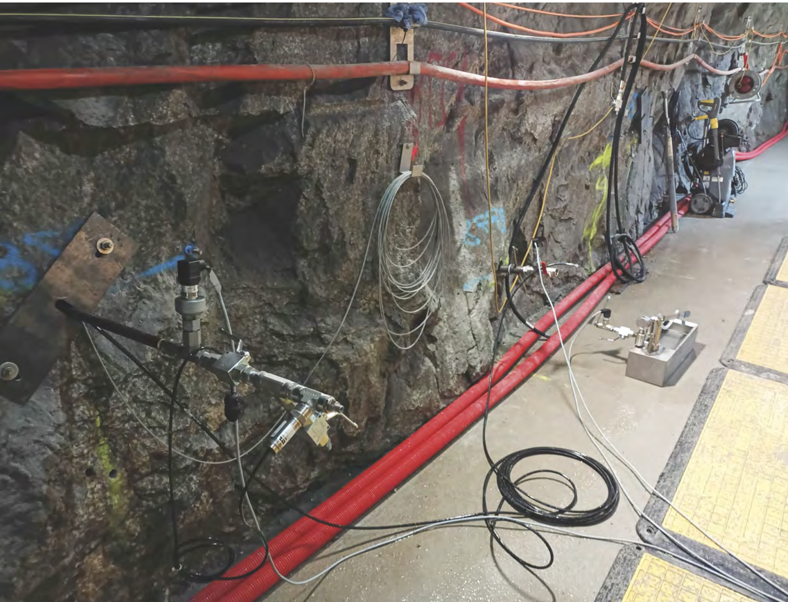
Versuchsaufbau für die Baustoffinjektionen im Untertagelabor (BULGG)
