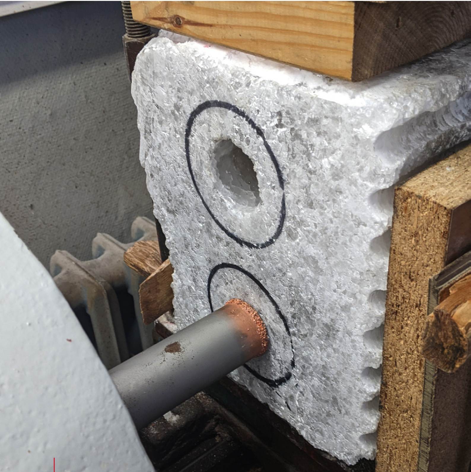
Vorbereitung des Steinsalzprüfkörpers durch zwei Kernbohrungen (Quelle: IfG, Leipzig)
