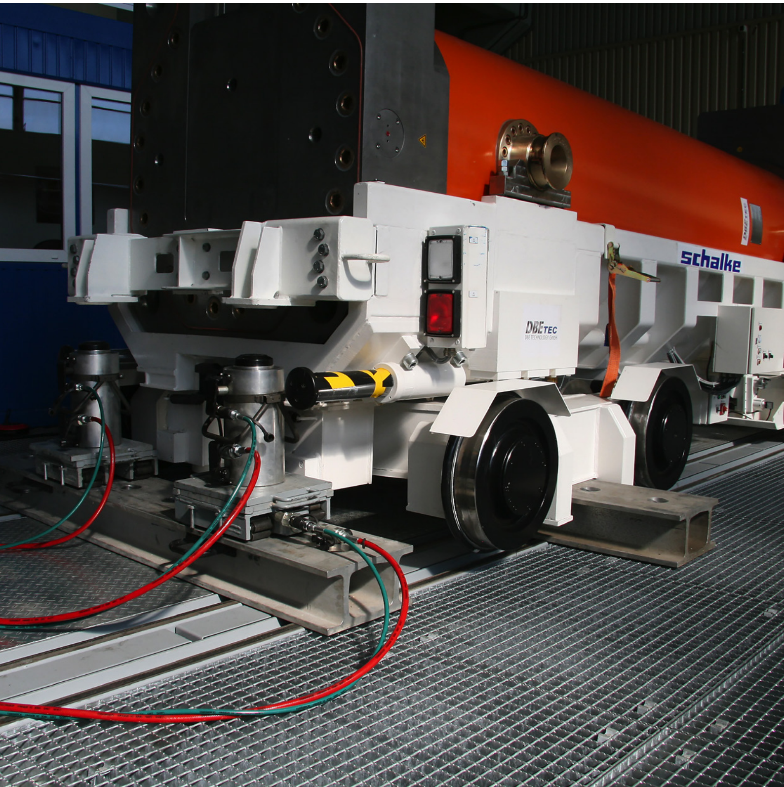
Großversuch zum Eingleisen eines entgleisten Plateauwagens mit Transportbehälter
