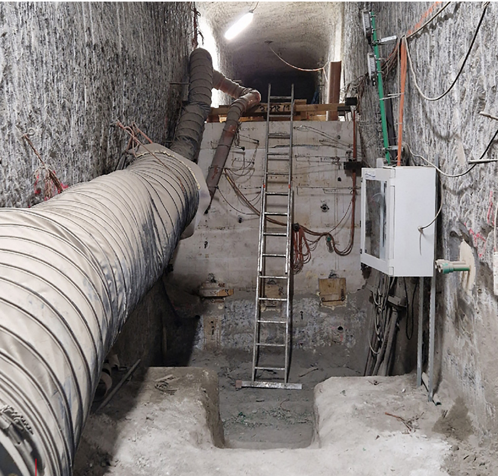
In-situ-Test für einen Streckenverschluss im Salz, Projekt STROEFUN, Bergwerk Teutschenthal
