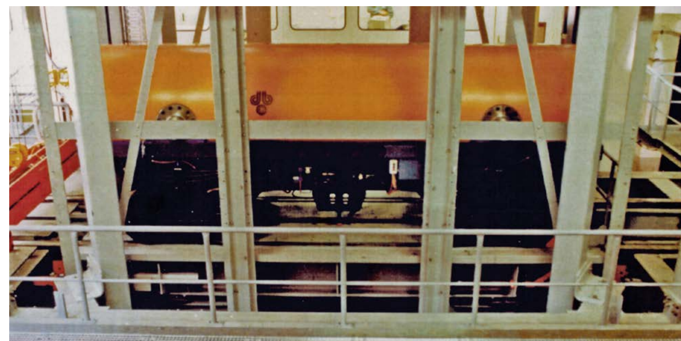
Demonstrationsversuch für den Schachttransport von Endlagerbehältern
