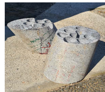
Freiberger Gneis (metamorph überprägter Granit mit ausgeprägter Anisotropie) als Gesteinsmaterial zur Eigenschaftsbestimmung
