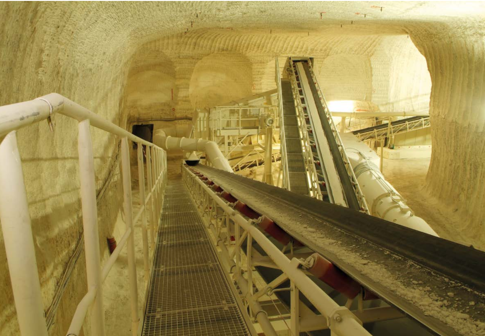
Anlage zur Salzaufbereitung für die Sorelbeton-Herstellung, Schachthanlage Asse
