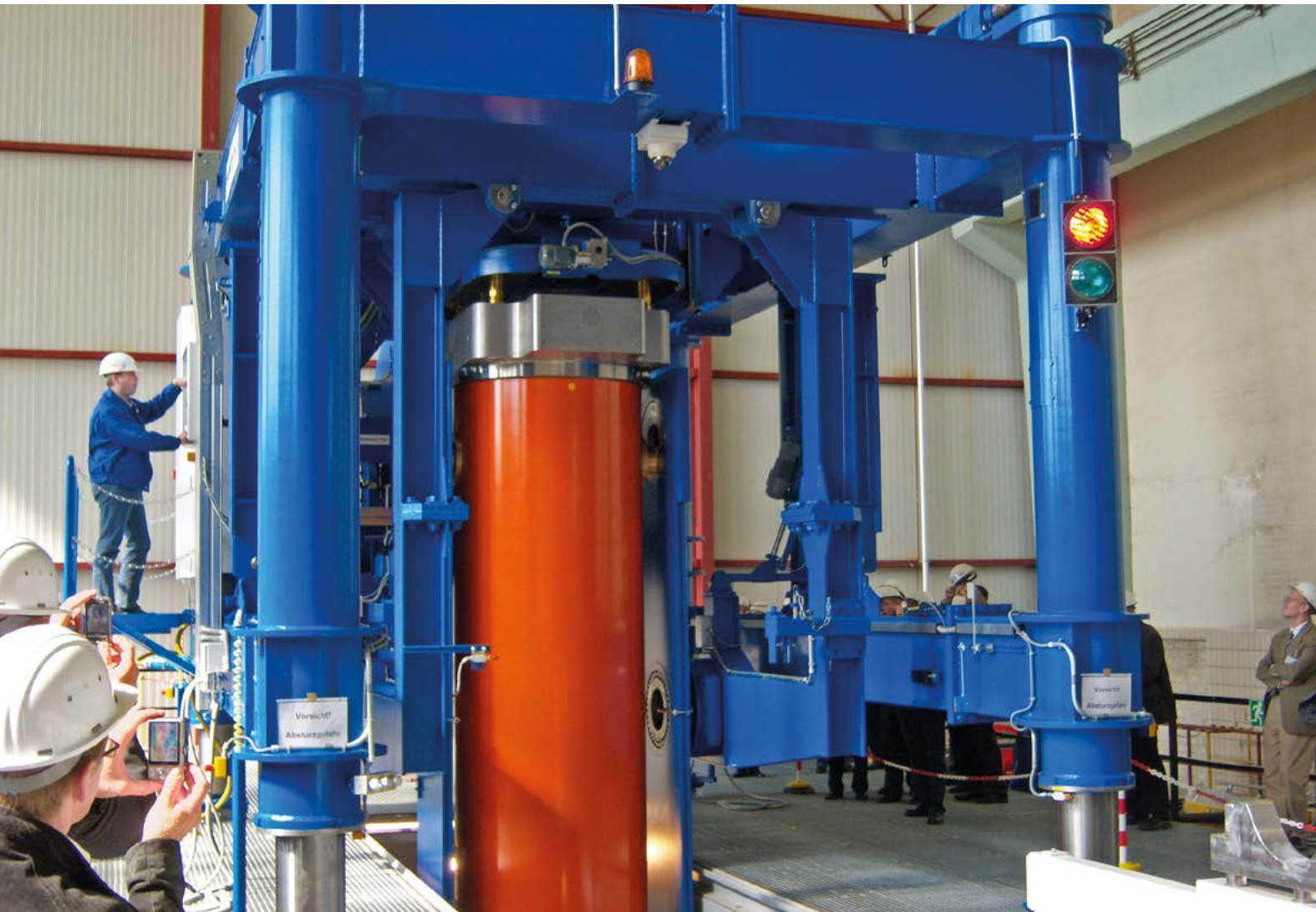
Demonstrationsversuch für die Bohrlochlagerung von Brennstabkaskillen, Maschinenhalle in Landesbergen (Nienburg/Weser)
