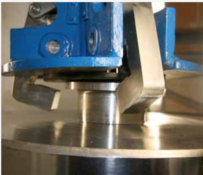
Demonstrationsversuch zur Einlagerung von Brennstabkockillen in vertikalen Bohrlöchern.
