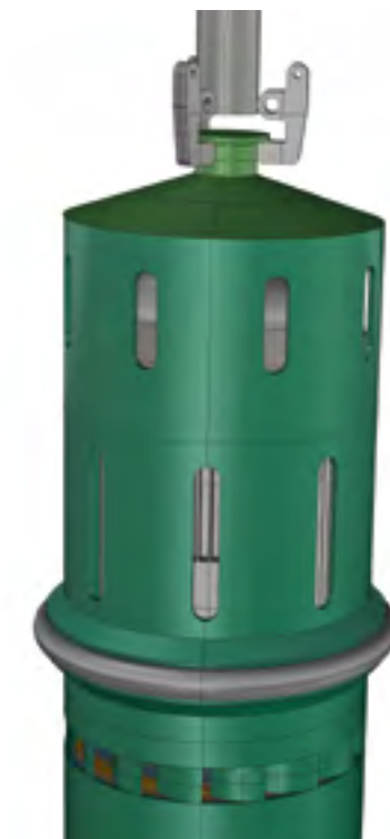
Konzept einer Saugglocke (Kopfbereich) zum Entfernen von lockerem Verfüllmaterial aus einem Einlagerungsbohrloch
