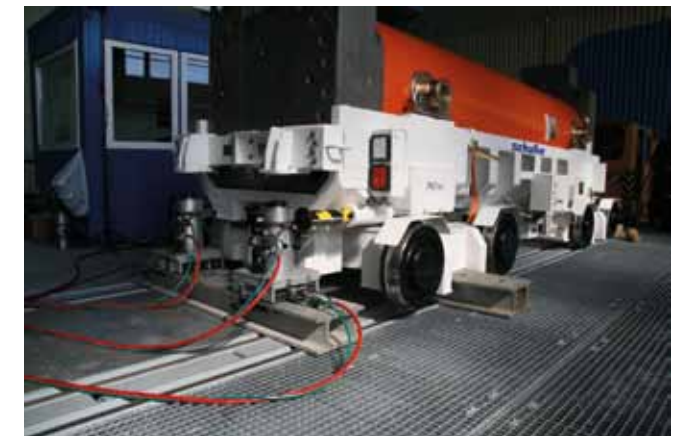
Demonstrationsversuch zur Beseitigung einer betrieblichen Störung: Eingleisen eines entgleisten Plateauwagens mit Transferbehälter
