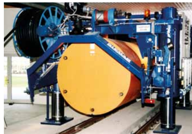
Demonstrationsversuch für die Einlagerung von POLLUX®-Behältern mit Brennstäben ausgedienter Brennelemente
