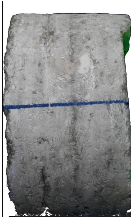
Abbildung 4-16: Mantelfläche des Probekörpers vom OFP 3 mit deutlichen konturparallelen Rissstrukturen
