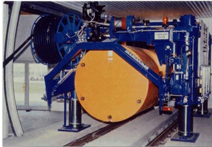
Abbildung 7: Photo der Einlagerungsvorrichtung in Strecken im Versuchsstand (Engelmann et al., 1995)
