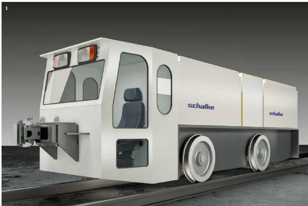
Abbildung 110: Darstellung der Produktionslokomotive SMT-M-100-BDE der Firma Schalke (Schalke, 2016)
