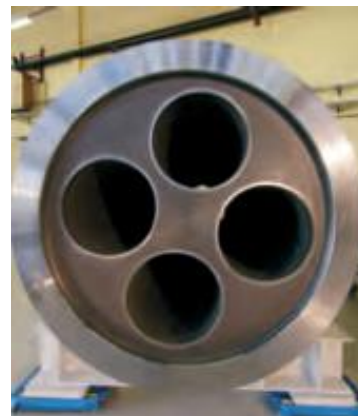
Abbildung 7: Französisches Behälterkonzept für Stahlbehälter für die Endlagerung von Kokillen mit verglasten Spaltproduktlösungen aus der Wiederaufarbeitung [144] (l.) sowie das Konzept für eine optionale direkte Endlagerung von Brennelementen [45] (Versuchskörper m., Schema r.).
