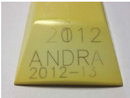
Abbildung 15: Probegravur auf der Gleitkufe eines französischen Kategorie-C-Behälters (vergl. Abbildung 7 links) [81].
