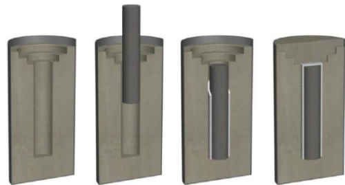
Abbildung 6: Assemblierung eines belgischen Supercontainers aus dem vorgegossenen Betonkörper, dem Stahlbehälter und dem anschließenden Vergießen mit Beton [21]
