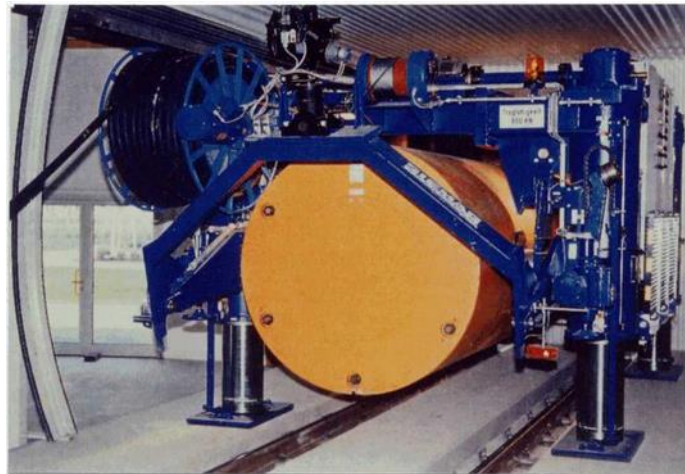
Abbildung 4-1: Einlagerungsvorrichtung mit POLLUX®-Behälter-Dummy /GRS 2011b/
