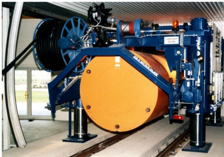
Abbildung 4-3: Einlagerungsvorrichtung für die Streckenlagerung von POLLUX®-Behältern /GRS 2011a/
