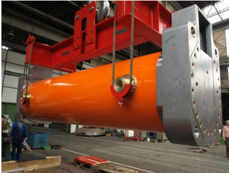
Abbildung 3-19: Transferbehälter für Brennstabkokillen und Triple-Packs /DBETEC 2010a/
