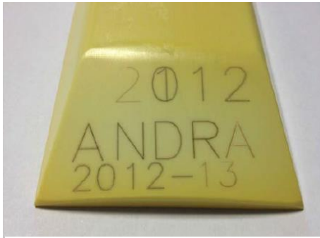
Abbildung 82: Behälteridentifikation auf einer keramischen Gleitkufe [385]. An jedem HAW-Endlagerbehälter befinden sich 12 solcher Kufen zur Vereinfachung von Einlagerung und eventueller Rückholung aus der Einlagerungsstrecke.
