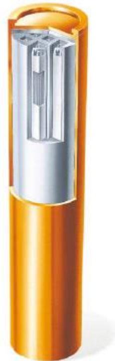
Abbildung 21: Der schwedische KBS-3-Behälter, hier die Ausführung für 12 SWR-BE [275]
