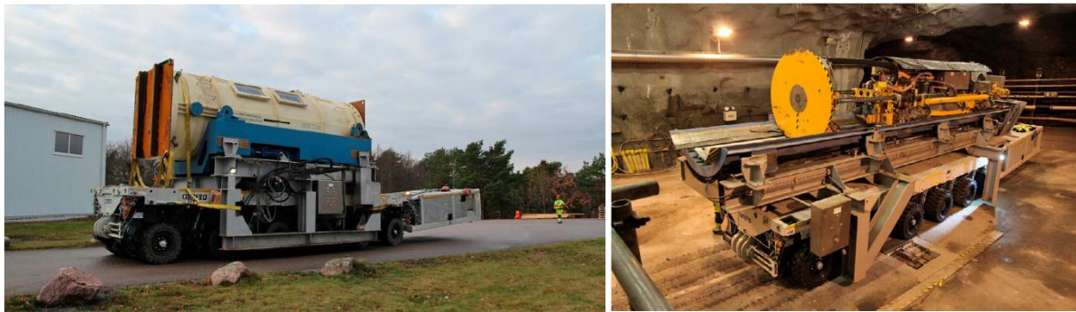
Abbildung 55: Transportfahrzeug MODE für den KBS-3H-Supercontainer (l.) und Einlagerungsmaschine auf dem Transportfahrzeug im schwedischen Untergrundlabor Äspö (r.) [628].
