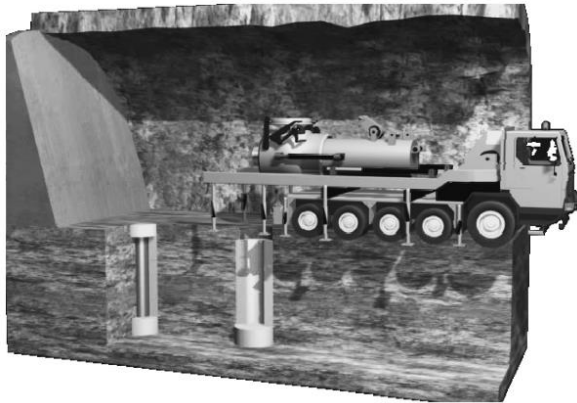
Abbildung 66: Das Behältertransferfahrzeug in teilverfüllter Einlagerungsstrecke, entsprechend dem KRS-Konzept [220].
