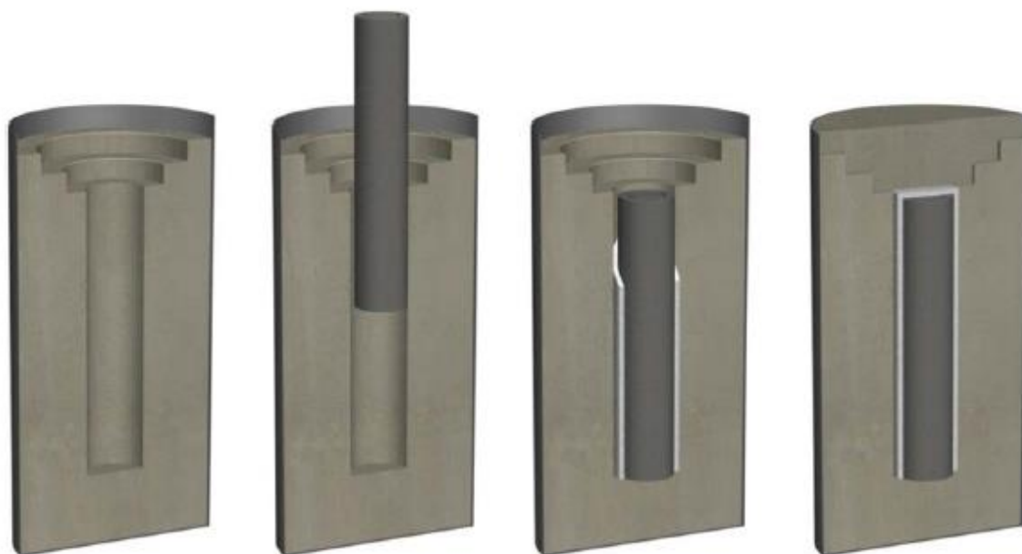
Abbildung 5: Fertigungsphasen des belgischen Supercontainers, aus [115]. V. l. n. r.: Stahlmantelung und Betonkörper; Einsetzen des Abfallkanisters; Gießen des Füllmaterials; Eingießen des Deckels.
