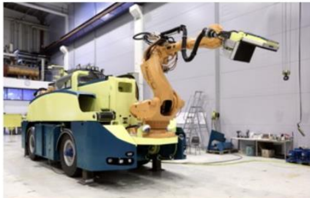
Abbildung 51: Prototypmaschinen für die Einlagerung der KBS-3-Behälter im finnischen Endlagerprojekt ONKALO. Oben: Einbringung des Bentonit-buffers; Mitte: Transfer- und Einlagerungsfahrzeug; unten: Spezialkran zum Verfüllen der Einlagerungsstrecken [152].
