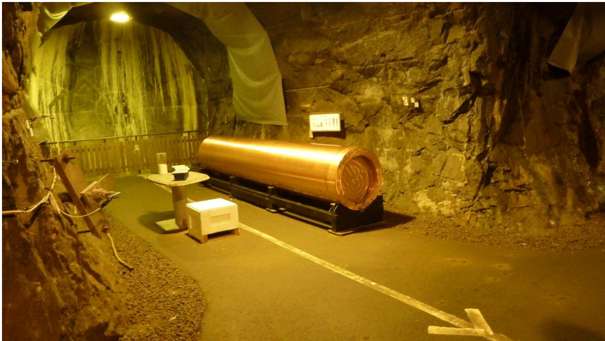
Abbildung 52: KBS-3-Behälter im Untergrundlabor Äspö nahe Oskarshamn [617]
