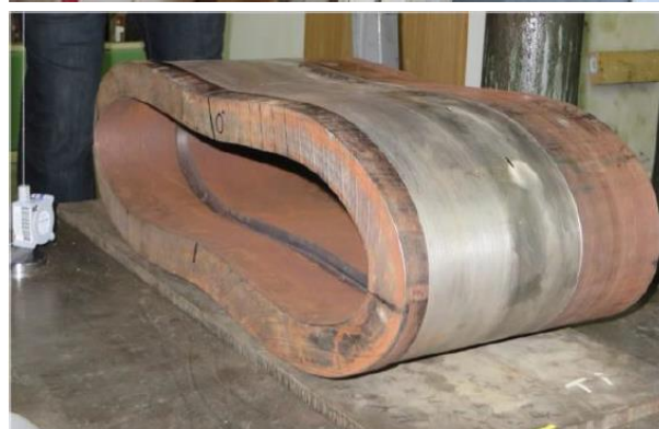
Abbildung 59: Fertigungs- und Materialtests des UFC-Mk.-II- Behälters. V. o. n. u. ein Demonstrationsbehälter mit abgenommenem Deckel und Kupfer- beschichtung, 2 geschweißte Behälter und ein Lasttest. Der Segmentring wurde zerdrückt, ohne dass die geprüfte Schweißnaht dabei riss [572].
