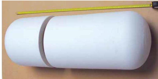
Abbildung 106: Probefertigung eines keramischen HLW-Endlagerbehälters auf Alumina-Basis im Maßstab 1:2 [606]
