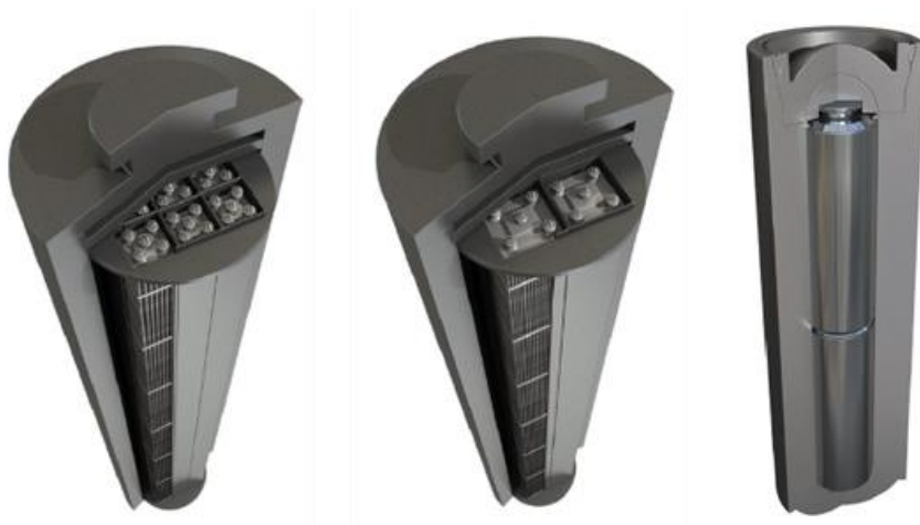
Abbildung 3-6: Die stählernen Schweizer Referenzbehälter für (v.l.) 9 SWR- oder 4 DWR-Brennelemente und für 2 Kokillen [40].
