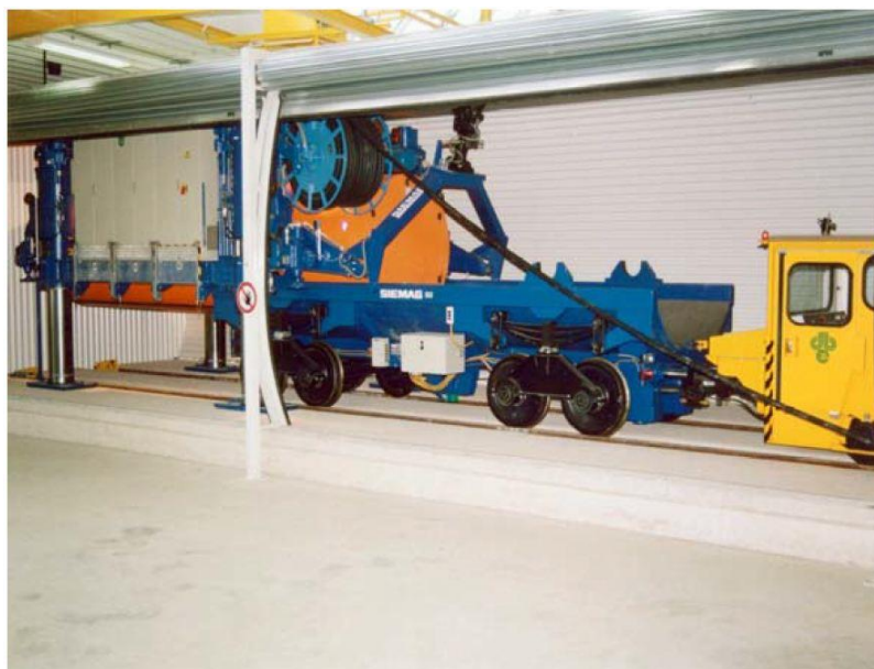
Abbildung 3-1: Einlagerungsvorrichtung in Strecken mit Plateauwagen und Batterielokomotive
