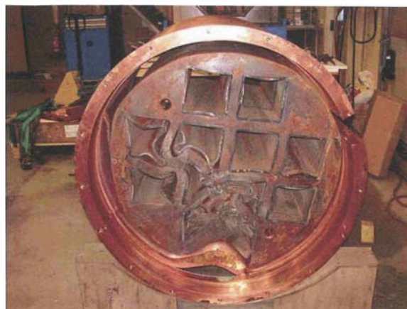
Abbildung 2-30: Finnland – SWR-BE-Behälter nach zerstörendem Drucktest /2-22/
