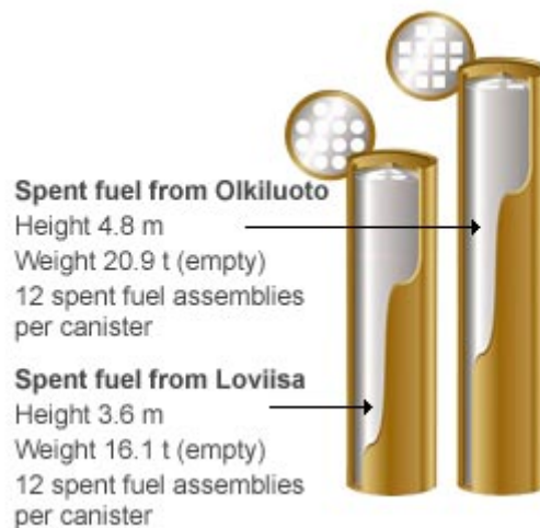
Abbildung 2-18: Finnland – Varianten von kupferummantelten Behältern für ausgediente Brennelemente /2-23/
