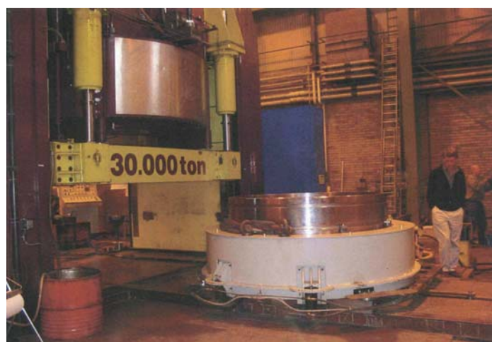
Abbildung 2-8: Schweden – Fertigung von Bentonitringen /2-18/
