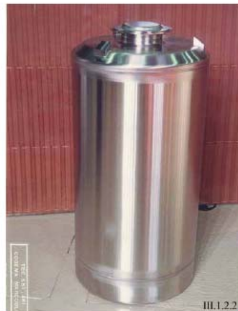
Abbildung 3-15: Frankreich – 175 l - Primärbehälter für verglaste HAW (Links - C0.2, C1 bis C4, rechts - C0.3) /3-26/
