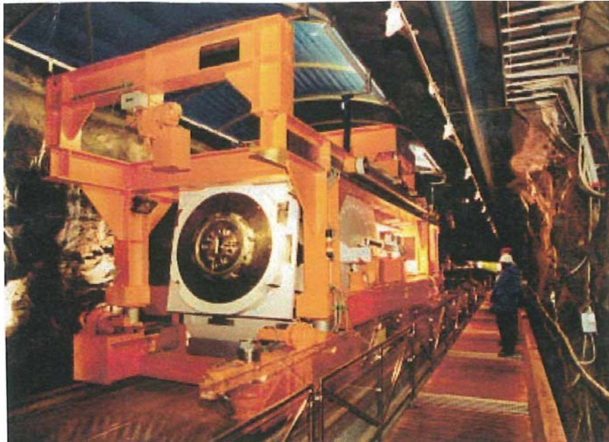
Abbildung 2-14: Schweden – KBS-3V-Konzept; Einlagerungsmaschine im URL Äspö /2-18/
