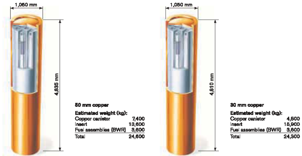
Abbildung 2-2: Schweden – Varianten von kupferummantelten Containern für ausgediente Brennelemente /2-6/
