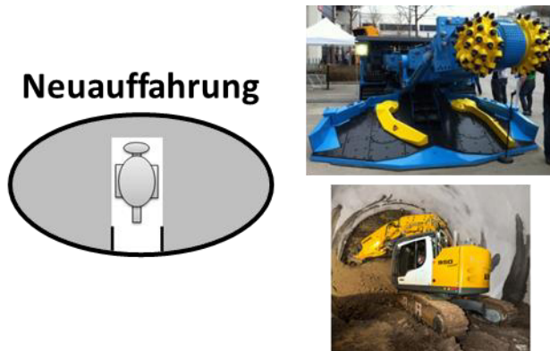
Abbildung 4-2: Mögliche Vortriebs-technik für die Neuauffahrung und Aufwältigung bereits verfüllter Strecken
