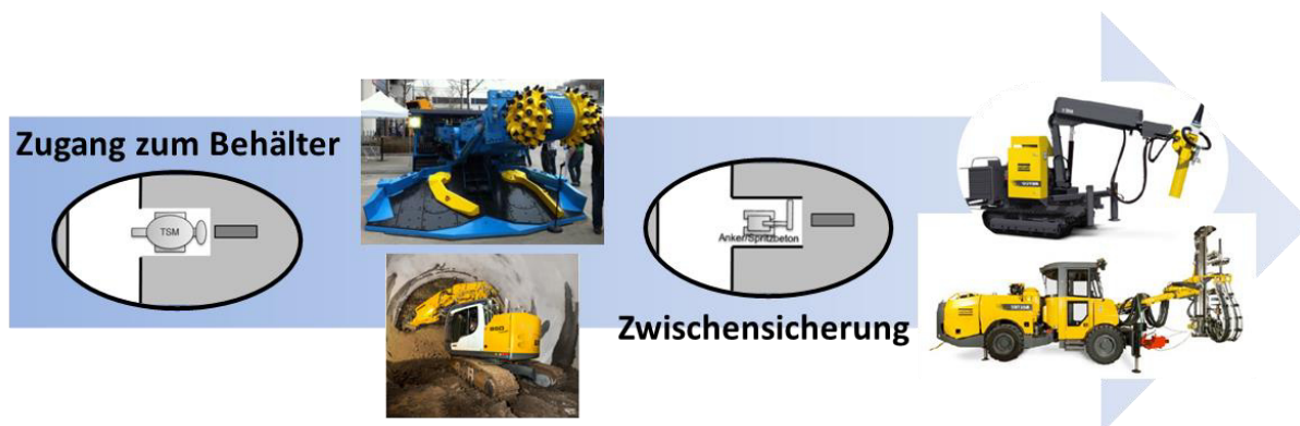
Abbildung 4-7: Schematische Darstellung zur Auffahrung der Rückholungsstrecken
