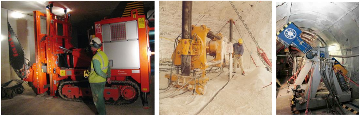
Abbildung 4-5: Anwendungsbeispiele Kettenschrämmaschine, links: Natursteingewinnung (Fantini, 2016), mitte: Erkundungsbergwerk Gorleben (DBE TEC, 2010a), rechts: Schlitzsäge im URL Bure (Bock et al. 2010)
