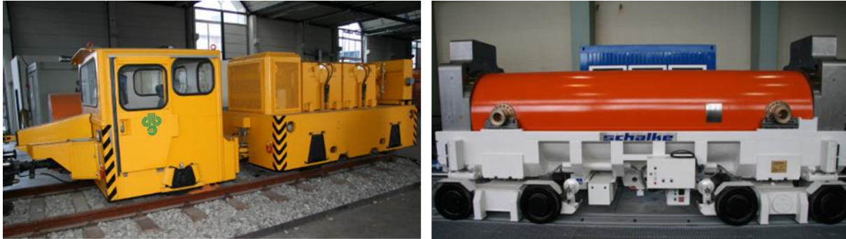
Abbildung 3-5: Batterie Lokomotive mit Führerhaus und Energieteil (links) und Plateauwagen mit Transferbehälter (rechts), (DBE TEC 2010b)
