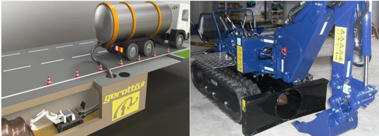
Abbildung 4-6: Biespiele für den Einsatz von Saugbaggern im Tiefbau (Gerotto, 2017)
