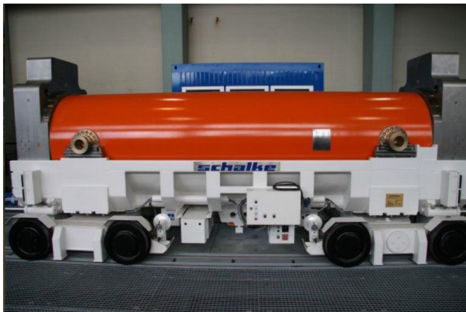
Abbildung 2-3: Mit dem Transferbehälter beladener Plateauwagen (GRS, 2011a)
