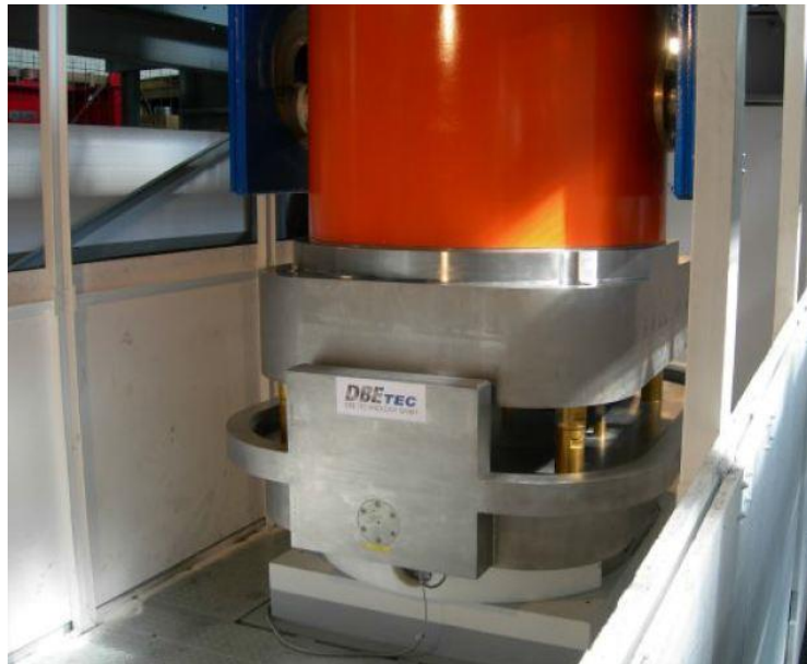
Abbildung 2-7: Einstellen des Transferbehälters auf die Bohrlochschleuse (GRS, 2011a)
