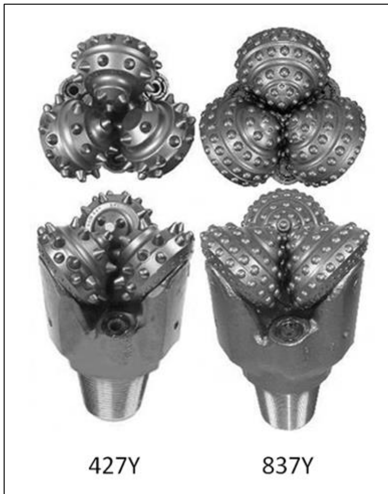
Abbildung 10: Vergleich: Rollenmeißel für weichere (rechts) und härtere (links) Formationen
