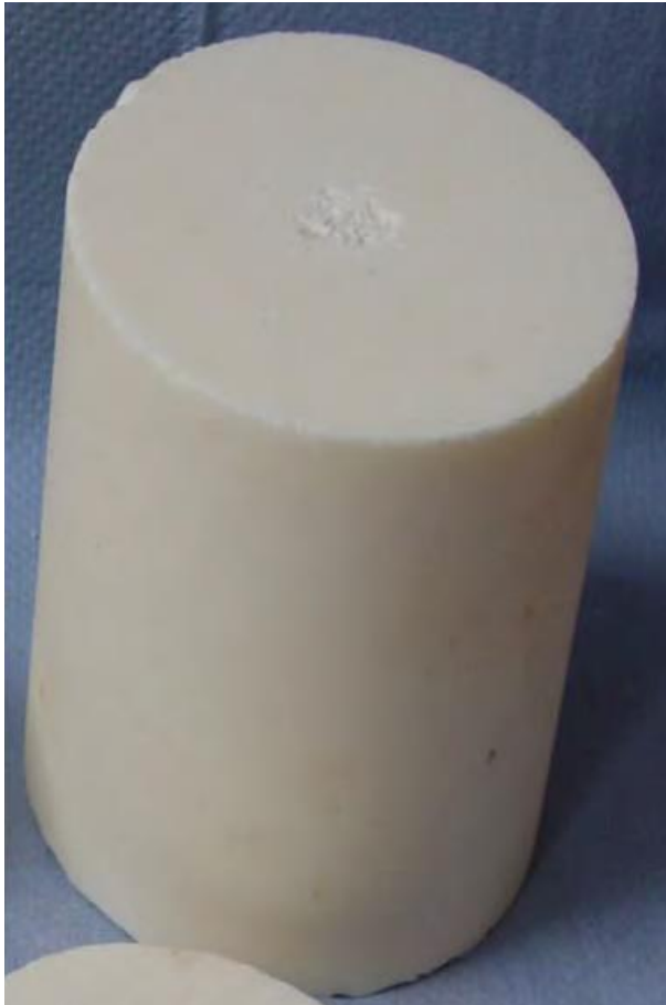
Abbildung 57: Rekristallisierte eutektische Salzschnmelze (HITEC salt) (Minkley, et al., 2017 S. 104)
