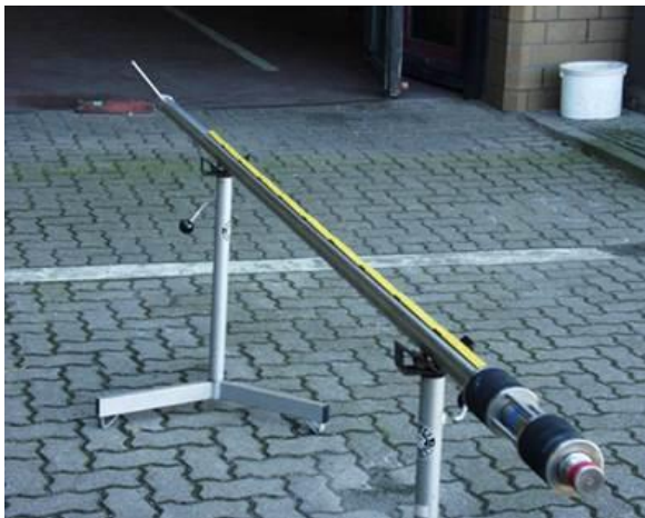
Abb. 4.27: Kurzintervall-Packer zur Messung von Gesteinspermeabilitäten im Streckennahbereich (Quelle: BGR).
