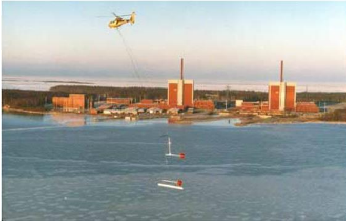
Abb. 4.15: Einsatz aerogeophysikalischer Messungen bei der geologischen Erkundung des finnischen HAW-Endlagerstandortes Olkiluoto (Mc Ewen & Äikäs 2000).
