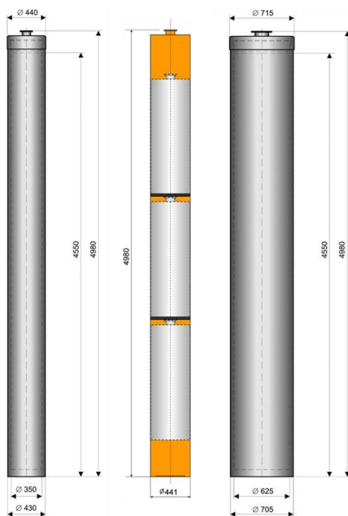
Abb. 3.1: Vergleich von BSK-3 und dem Behälter aus dem KBS-3-Konzept (Raiko 2012, Filbert et al. 2010)
