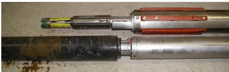
Abb. 4.21: Gerät zur Durchführung von Überbohrversuchen in tiefen Erkun- dungsbohrungen zur Ermittlung der Gebirgsspannungen am Standort Olkiluoto, Finnland („Borre probe“, SwedPower, Posiva 2005).
