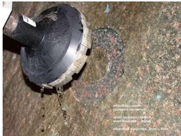
Abb. 4.28: Vorbereitung eines hydraulischen Tests zur Bestimmung der hydraulischen Durchlässigkeit der Auflockerungszone mittels Oberflächenpacker im URL Äspö (Quelle: BGR).
