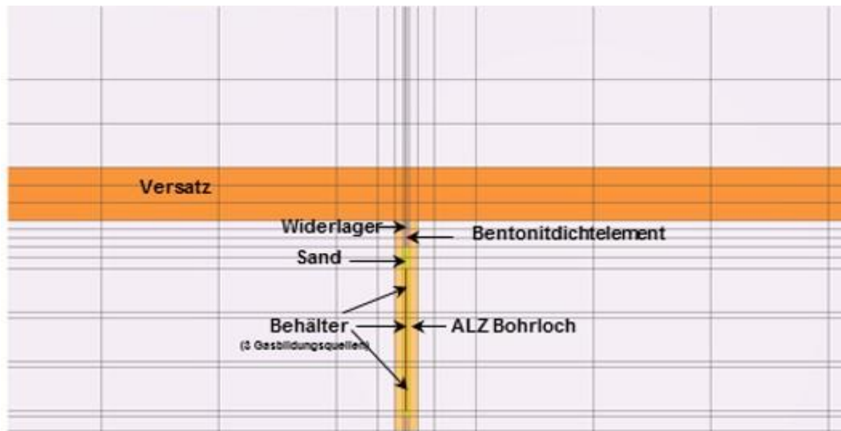
Abb. 3.2: Modellnetz mit Diskretisierung im Bohrloch- und Streckenbereich, vertikaler 2D-Schnitt
