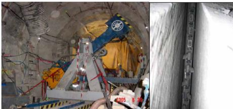
Abb. 3.4: Großversuch zur Erstellung von Schlitzern zur Unterbrechung der Auflockerungszone (KEY-Versuch) im Untertagelabor in Bure (Frankreich) ANDRA (2005).
