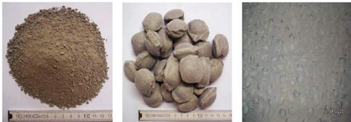
Abb. 3.21: Komponenten der Bentonitdichtung, links Bentonitgranulat 0–3 mm, mitte: Bentonitpressinge, binäres Gemisch im Einbauzustand (Wilsnak et al. 2008)
