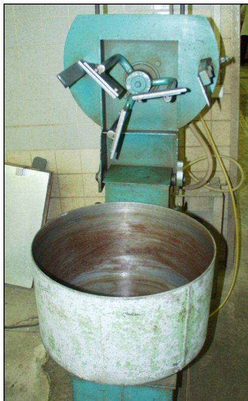
Abbildung 4-4: Laborzwangsmischer gemäß DIN 459 /4-26/, Teil 1 (vgl. ISO D15 18650 /4-27/, Teil 1, Ferraris /4-28/).
