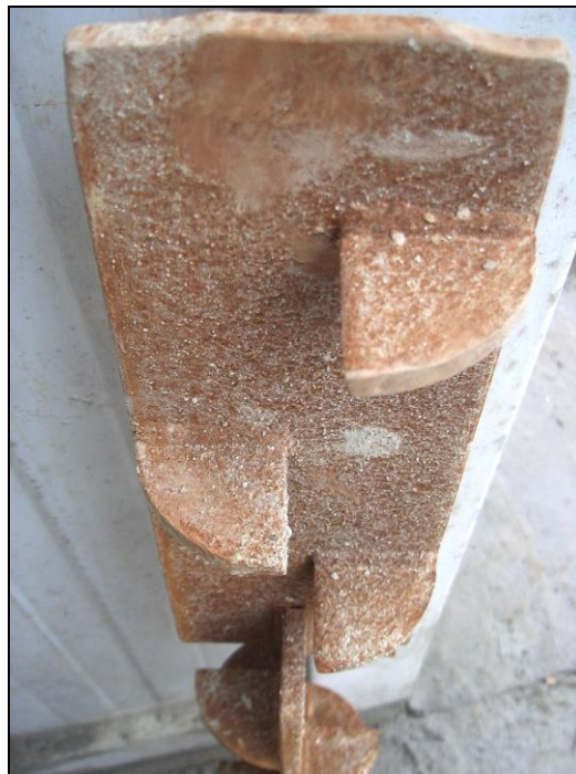
Abbildung 4-2: Stahleinsatz eines statischen Rohrmischers. Breite ca. 12 cm.
