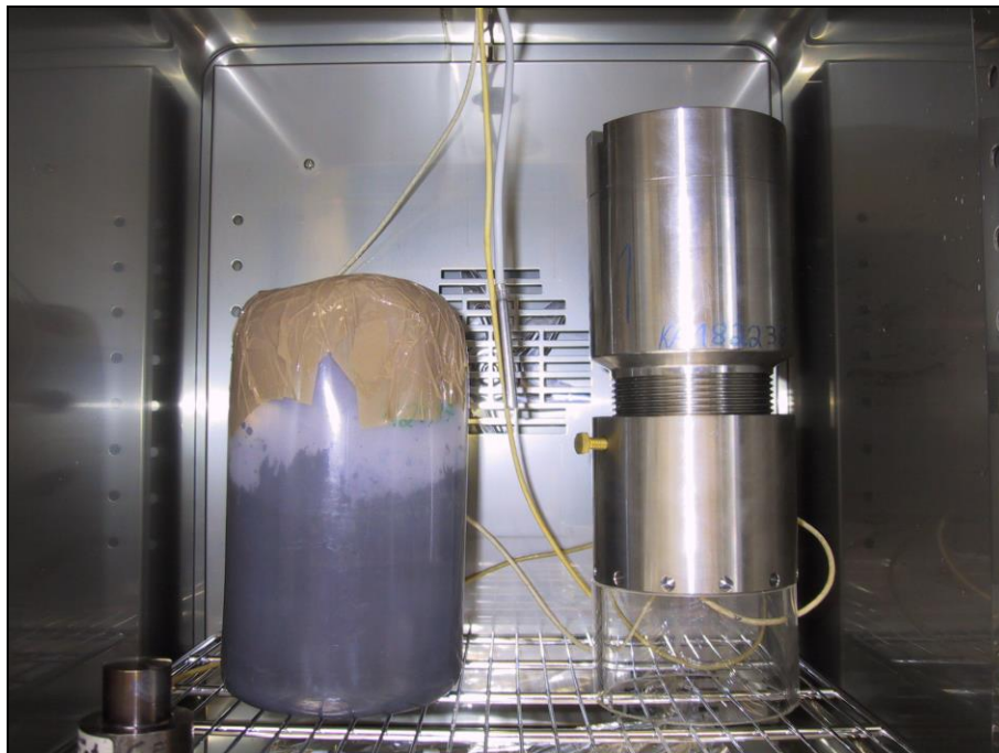
Abbildung 4-35: GRS-Druckzelle (rechts) zur Messung des Kristallisationsdruckes erhärtender Baustoffmischungen. Neben der Druckzelle wurde stets Probematerial der Suspension in einer PE-Flasche gelagert.
