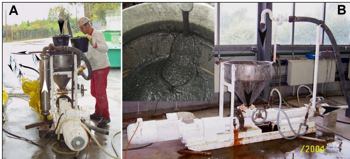
Abbildung 4-17: Überblick des Messsystems (links, A) und Detailaufnahme der drehzahlgesteuerten Pumpe (rechts, B).
