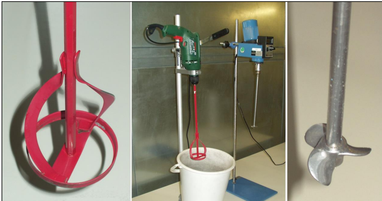
Abbildung 4-3: Mischvorrichtungen zur Erstellung von Suspensionen. Links: Mörtelmischer mit Bohrmaschinenantrieb; rechts: Labormischer mit Mischerflügel.
