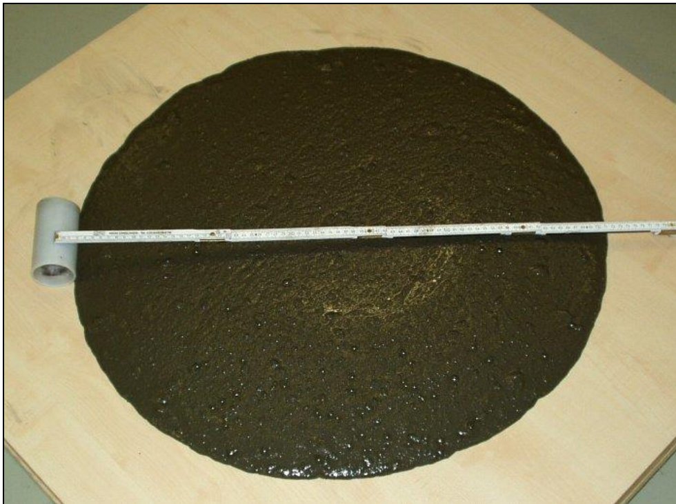
Abbildung 4-7: Ausbreitkuchen einer Mischung mit Kieserit („fein“), Auffahr-/Frässlösung, Tonmehl und Wasser. Das Wasser wurde zuerst mit dem Steinsalzzuschlag, zur Erzielung einer NaCl-Sättigung, vermischt.
