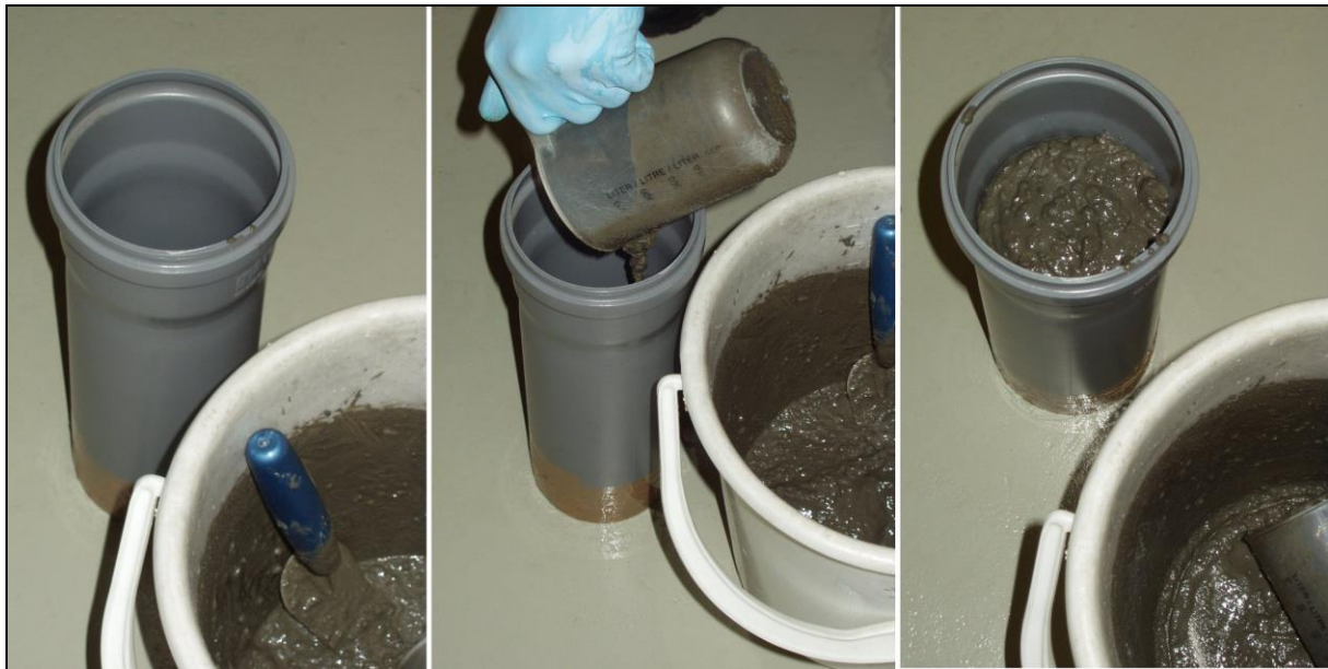
Abbildung 4-38: Herstellung von Probekörpern zur Bestimmung der einaxialen Druckfestigkeit sowie des statischen Elastizitätsmoduls (Innendurchmesser der Kunststoffrohre 100 mm).
