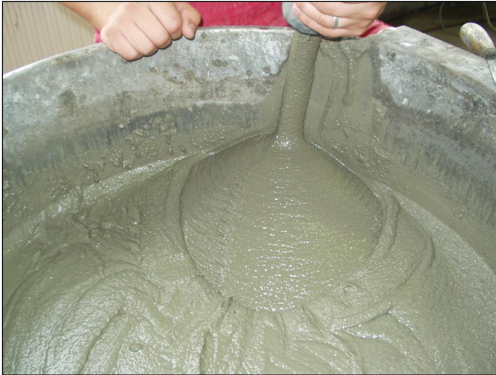
Abbildung 4-22: Suspension der Rezeptur 2 nach 30minütigem Förderprozess im Rohrviskosimeter.
