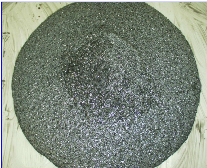
Abbildung 4-6: Ausbreitkuchen einer Mischung mit \text{MgSO}_4 -wasserfrei (calciniert, Gewerbesalz, Mikrosilica, und einer natürlichen IP21-Lösung. Die Kunststoffplatte wurde in diesem Fall mit einer Mischung aus Mikrosilica und IP21-Lösung befeuchtet. Eine gleichmäßige „mattfeuchte“ Oberfläche der Ausbreitplatte konnte jedoch nicht erzielt werden.
