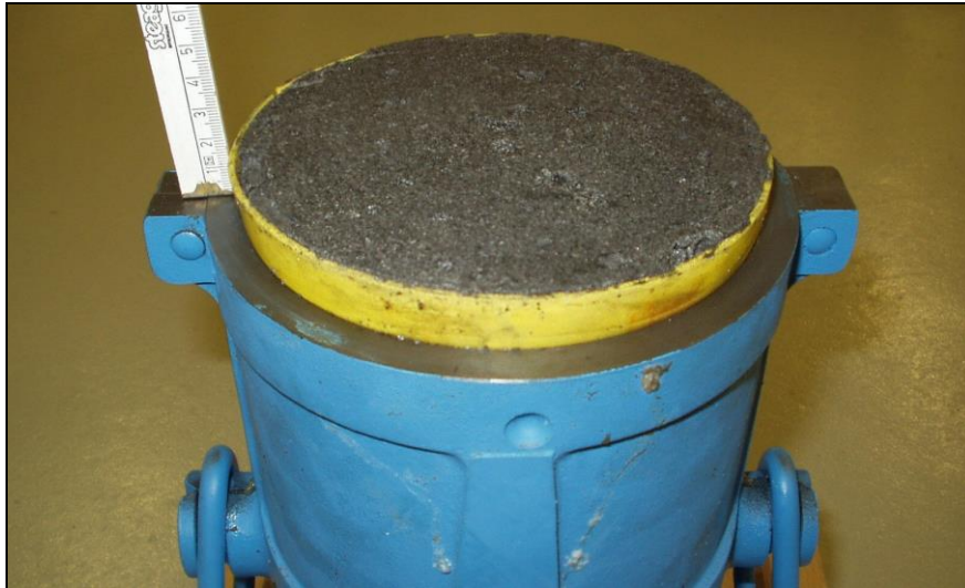
Abbildung 4-32: Volumenvergrößerung im Verlauf des Erhärtungsprozesses der Referenzmischung \text{MgSO}_4 . Probekörperform mit einem Durchmesser von 150 mm.
