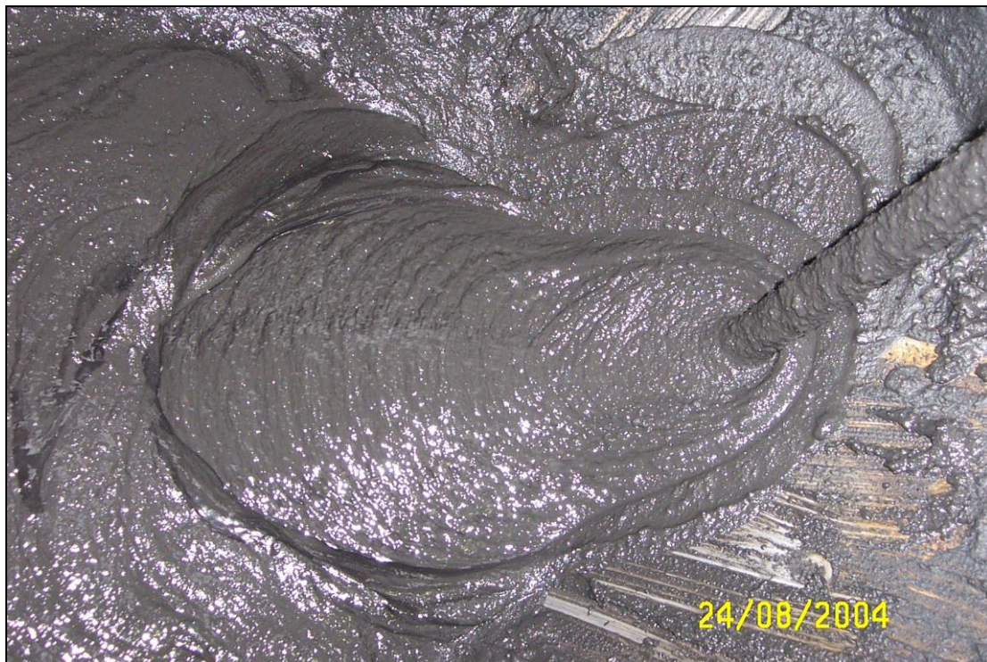
Abbildung 4-20: Suspension der Rezeptur 1 nach etwa 4stündiger Versuchsdauer beim Einfließen in den Vorlagebehälter des Rohrviskosimeters.
