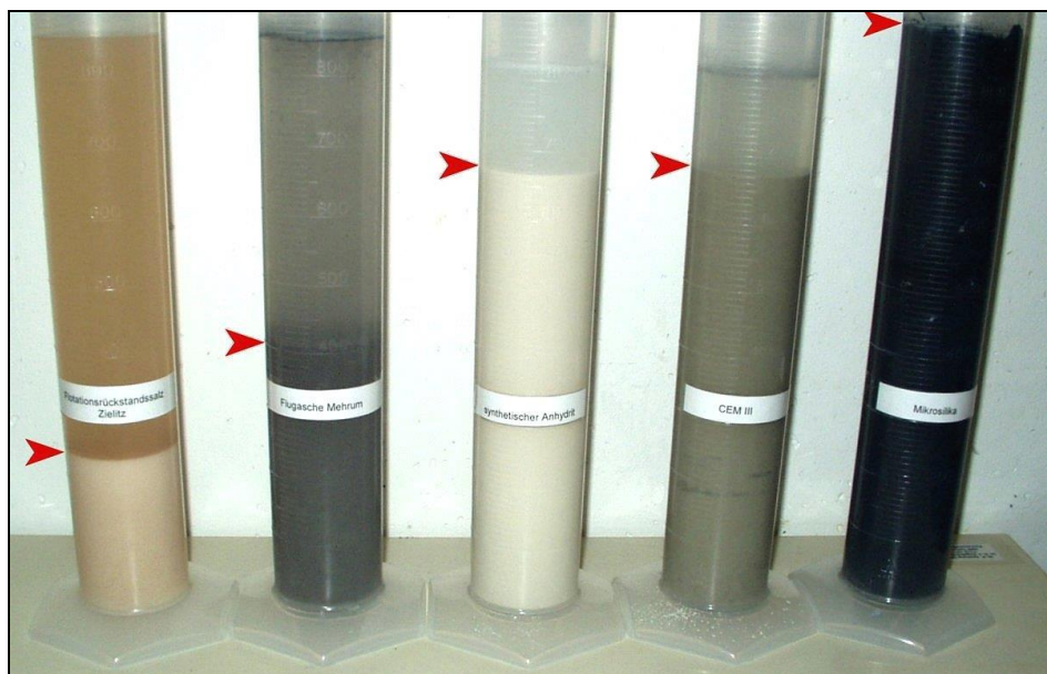
Abbildung 2-1: Messreihe zur Ermittlung der Sedimentationsrate von Salzzuschlag, Flugasche, Anhydritpulver, Zement und Mikrosilica in gesättigter NaCl-Lösung.
