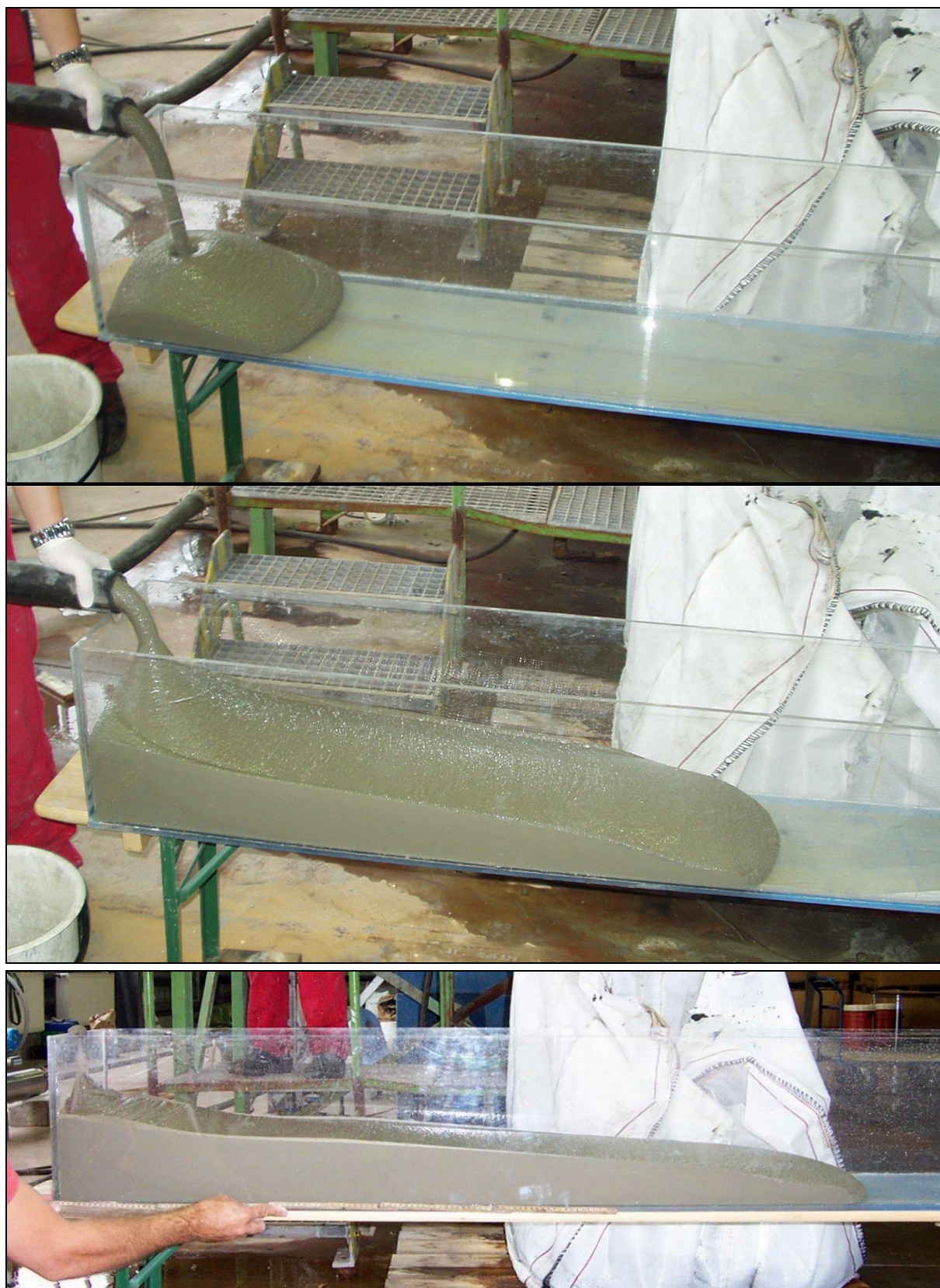
Abbildung 4-23: Rezeptur 2 beim Fließen in der Plexiglasrinne (Länge 2 m, Breite 27,7 cm). Insgesamt wurde ein Volumen von ca. 38 Liter bei einer Leistung von 45,5 l/min (2,73 m 3 /h) in die Rinne gefüllt.
