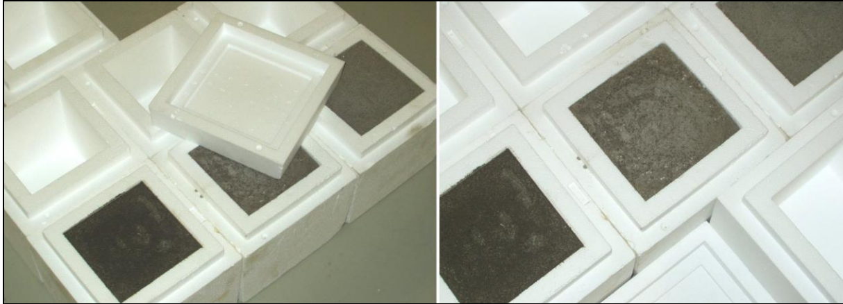
Abbildung 4-34: Probewürfel zur Bestimmung der Volumenzunahme von Baustoffen.
