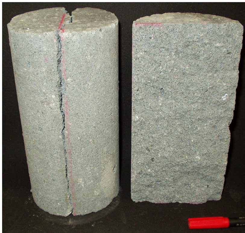
Abbildung 4-44: Probezylinder der Referenzmischung Kieserit im Anschluss der Prüfung der Spaltzugfestigkeit (Durchmesser 100 mm, Höhe 200 mm).
